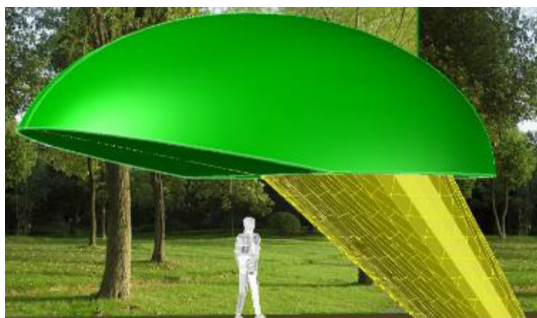
Estrutura sombreamento – composição com Elipsoide de Revolução e Cone Oblíquo modificados por seções planas
