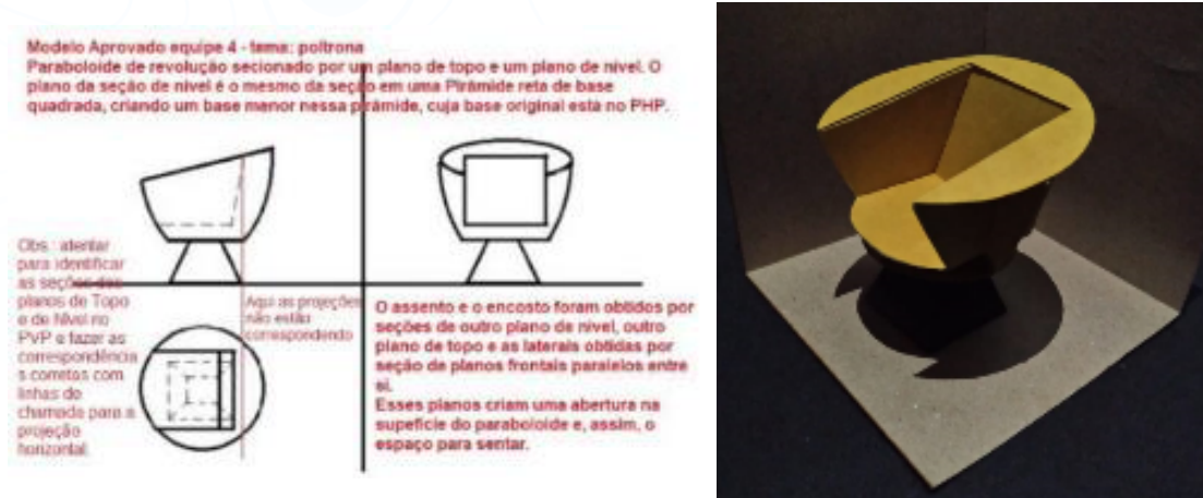
Figura 9 – Desenvolvimento de representação técnica e Maquete – composição com Parabolóide de Revolução modificado por seções planas e Pirâmide Retas: poltrona.
